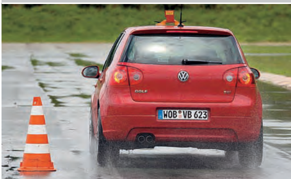
Beim Nassbremsen kommt der beste Pneu acht Meter früher zum Stillstand als der schlechteste
