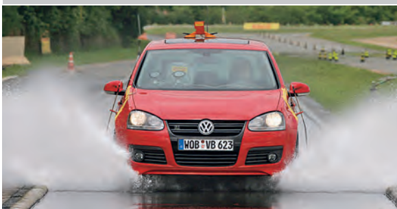
Beim Aquaplaning längs wird ermittelt, bei welchem Tempo der Reifen unkontrollierbar aufschwimmt
